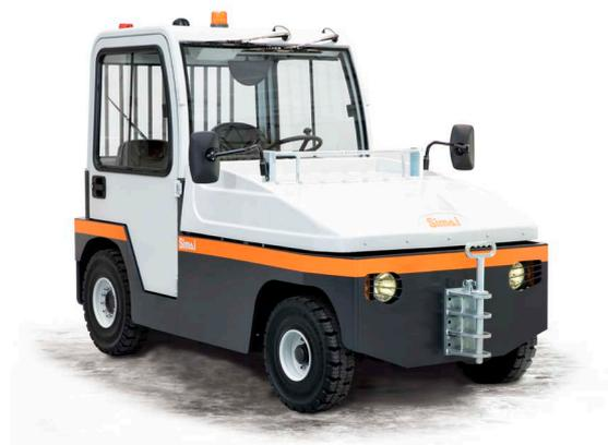
Tracteur à 4 roues, «homme à bord». Hautes performances, idéal pour les services lourds à longue portée dans les secteurs industriel et aéroportuaire. Le TE300R a une capacité de traction importante bien que sa taille et les rayons de braquage soient réduits. La position arrière de la cabine permet d'obtenir une distribution optimale du poids et une stabilité excellente. Plateau avant avec capacité de charge de 80 kg.
