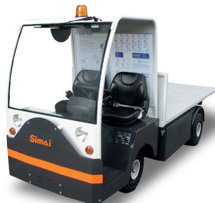
Porteur à plateau à 4 roues, « homme à bord », avec traction arrière. Extrêmement compact et maniable, idéal pour tous les services – aussi bien à l'intérieur qu'en plein air, également sur les longs trajets. Le porteur PE20 est prévu pour l'installation de nombreux équipements sur le plateau.
