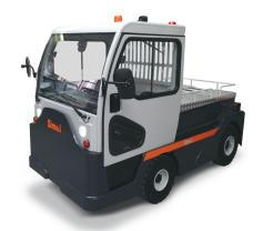
Tracteur à 4 roues, « homme à bord ». Hautes prestations, idéal pour les services lourds à longue portée dans les secteurs industriel et aéroportuaire. Le TE291 a une capacité de traction importante bien que sa taille et les rayons de braquage soient réduits. Grand plateau arrière avec capacité de charge de 200 kg.
