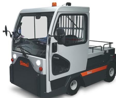
Tracteur à 4 roues, « homme à bord », avec traction arrière. Idéal pour tous les services intensifs - aussi bien à l'intérieur qu'en plein air. Grand plateau arrière avec capacité de charge de 200 kg.
