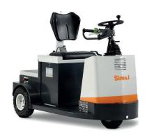
Tracteur à 3 roues, « homme à bord », avec traction arrière. Extrêmement compact et maniable, idéal pour les services de manutention LEAN.
