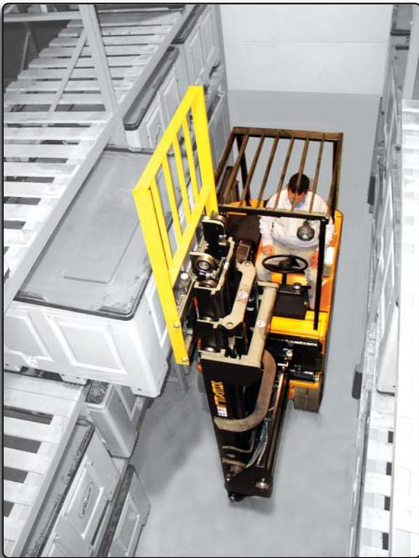
Avec des palettes standard, vous pourrez évoluer dans des allées inférieures à 2 mètres de large. La manutention de charges longues ne posera plus de problème grâce au châssis compact de seulement 1156 mm de large.
