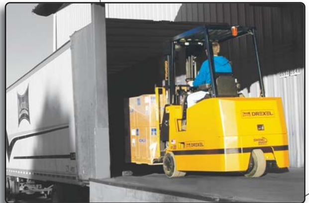
Deux capacités s'offrent à vous : 1500 kg et 1800 kg, avec une large gamme de mâts pouvant lever jusqu'à 7920 mm en versions Triplex ou Quadruplex.
