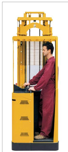
Maxi confort pendant les déplacements en ligne horizontale, grâce à la position de conduite transversale, l'opérateur se trouve dans les meilleures conditions de visibilité pour exploiter au maximum la vitesse de translation.
