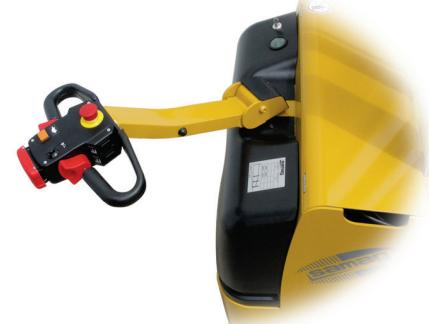
Tous les boutons de commande (traction, levage, descente des fourches) + fonctions lentes situés sur le boîtier à la tête de timon
