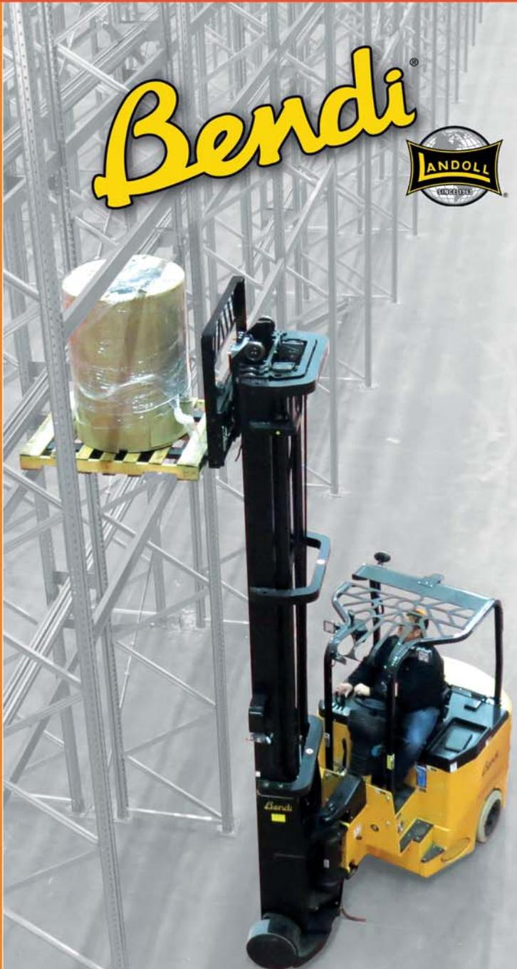
Les Bendi B40AC-HL et B50AC-HL sont des chariots électriques grande levée 4 roues équipés de 2 roues avant en polyuréthane souple et 2 roues arrière en pneus pleins souples. Optimisation de la densité de stockage en allées étroites, polyvalence, productivité et confort sont les maîtres-mots qui caractérisent ces chariots qui évoluent aussi bien en intérieur qu'en extérieur.
