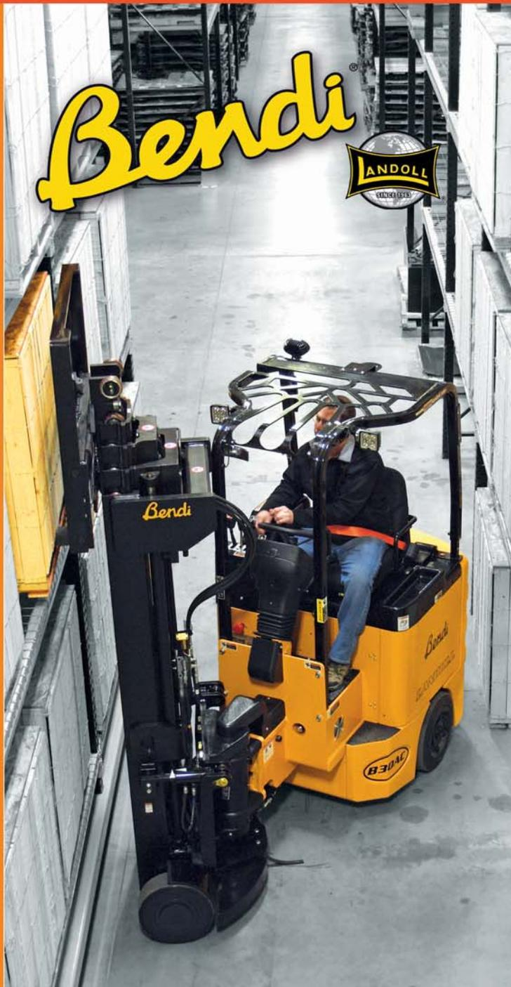
Les Bendi B30AC et B40AC sont des chariots électriques 4 roues équipés de deux roues avant en polyuréthane souple et deux roues arrière en pneus pleins souples. Optimisation de la densité de stockage en allées étroites, polyvalence, productivité et confort sont les maîtres-mots qui caractérisent ces chariots qui évoluent aussi bien en intérieur qu'en extérieur.
